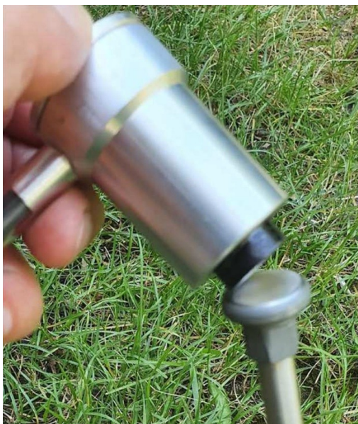
Obrázek 2: Snímač půdy: opatrně připevněte magnetickou hlavu
