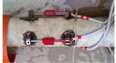
VW STRAIN GAUGES 4 WWW.SISGEO.COM
